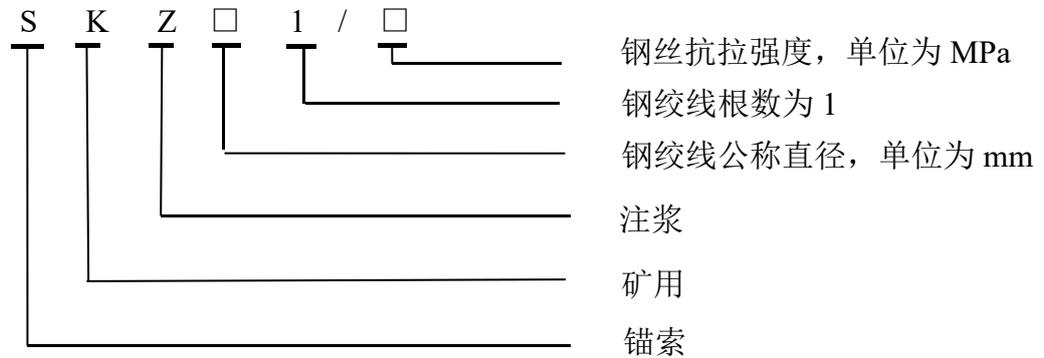
示例：SKZ25-1/1860×4500mm 表示公称直径为 25mm，长度为 4500mm，钢丝抗拉强度不小于 1860MPa 的中空注浆矿用锚索。
